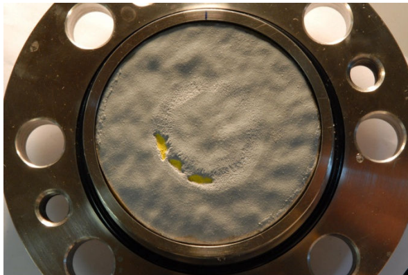
Image 8 : Eprouvette S2 après la phase 10
